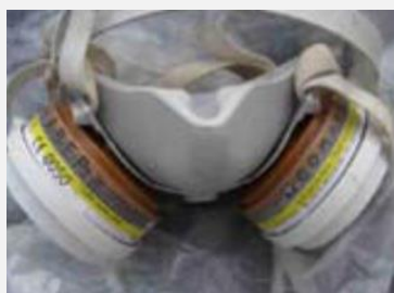
Photo 7 : Masque à cartouche A2P2 (bande marron) : source Guide COLEACP/PIP, Manuel 4
