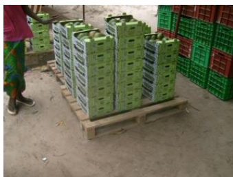
Photo 14 : Palettisation en plein air (mauvaise pratique)
